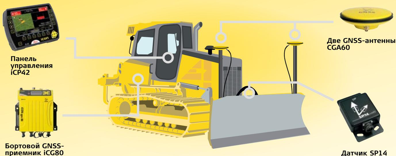
Сочетание современного датчика SP с двойной GNSS-антенной позволяют управлять техникой на полной скорости, в то же время как отвал будет сохранять требуемое положение и угол для эффективного распределения материала.
