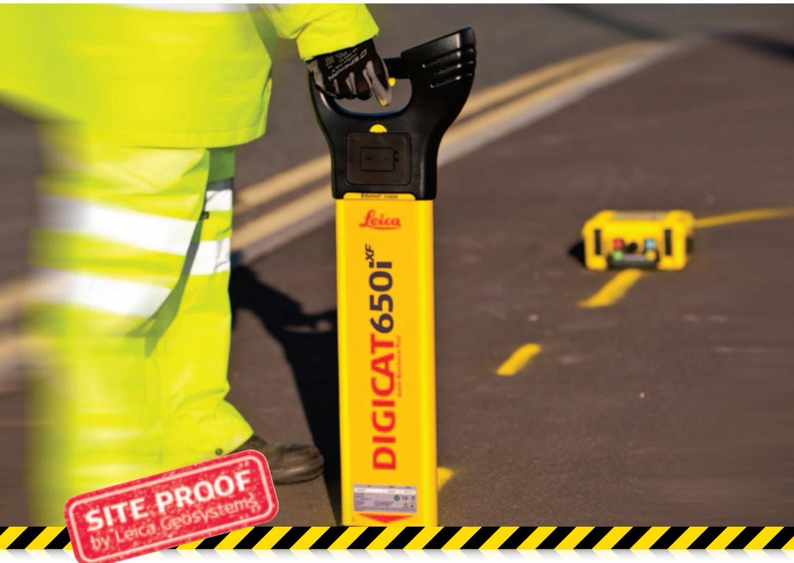
Локаторы и генераторы Leica Geosystems xf позволяют выполнить поиск подземных коммуникаций быстрее и точнее, чем раньше. Серия Leica Digicat xf специально разрабатывалась для увеличения дальности поиска. Поиск по низкочастотным сигналам показывает особенно хорошие результаты при исследовании канализационных сетей.
